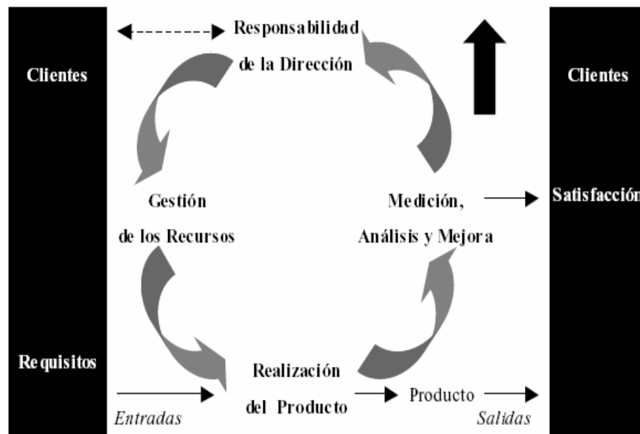
Figura 1 - Modelo de un sistema de gestión de la calidad basado en procesos
